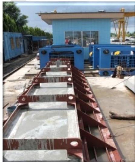
Hình 24. Cọc ván bê tông dự ứng lực
