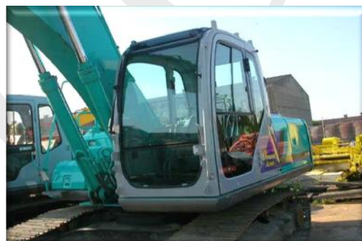
Máy đào kobelco sk200
