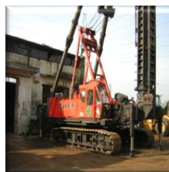
Cần cẩu P&H320 và dàn dẫn hướng đóng cọc bê tông
